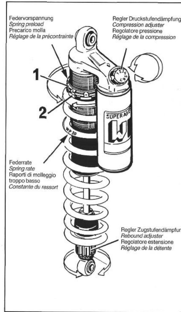
La corsa dovrebbe oscillare tra 85/100 mm. Il valore di 85 mm migliora la guidabilità nelle curve ma riduce leggermente la stabilità nei percorsi rettilinei, poiché si sposta più peso sulla ruota anteriore e si produce una geometria di sterzo più inclinata.
