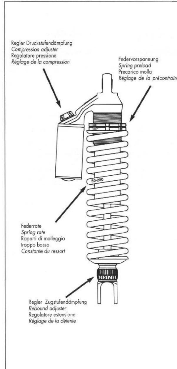
La corsa dovrebbe oscillare tra 85/100 mm. Il valore di 85 mm migliora la guidabilità nelle curve ma riduce leggermente la stabilità nei percorsi rettilinei, poiché si sposta più peso sulla ruota anteriore e si produce una geometria di sterzo più inclinata.
