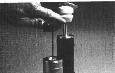
Avant de pouvoir travailler sur l'amortisseur, il faut faire disparaître la pression d'azote. Pour ce faire, mettez le réglage de la détente en position 1. Ensuite, à l'aide d'un tournevis, enlevez le petit bouchon en caoutchouc du réservoir et, en desserrant la vis de remplissage du réservoir avec
